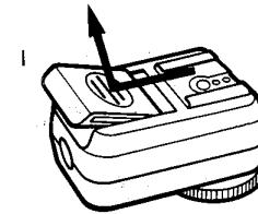
T90でストロボの多灯撮影をする場合あるいはストロボをカメラから離して撮影する場合に、コネクティングコード60/300、TTLオフカマラシューアダプターなどと併用するアダプターで、ホットショーオよび多灯撮影用のソケットを備えております。
